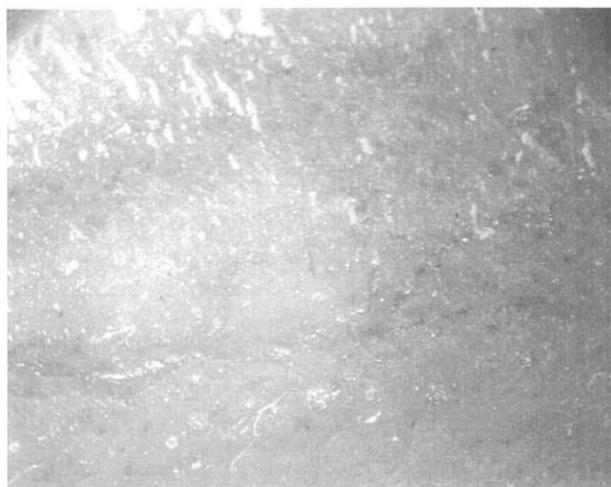
Photo 1 Texture du chert à radiolaires de la Formation d'Aubin en surface sèche. Bleutée par rapport à la couleur naturelle. Échelle : 1 cm = 1,2 mm.
