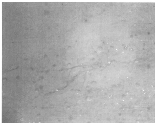
Photo 2 Texture du chert à radiolaires de la Formation d'Aubin en surface humide. Bleutée par rapport à la couleur naturelle. Échelle : 1 cm = 1,2 mm
